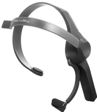
圖 8 NeuroSky MindWave 腦波偵測儀器
